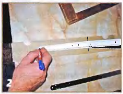
Отверстия с кронштейном я перенес фломастером на картон.
