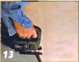
Криволинейный раскрой деталей из ДСП удобно делать электролобзиком.
