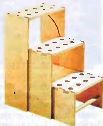
Лесенка-табурет. Средняя ступенька может перемещаться вверх по криволинейному пазу, давая возможность повернуть нижнюю ступеньку на 90°.
