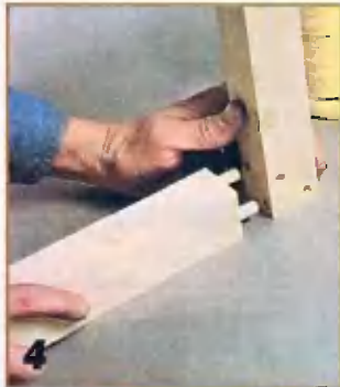
4 Правильность соединения на шкантах проверяют насухо, без клея.
