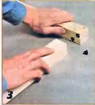
3 Для разметки ответных отверстий следует использовать игольчатые маркеры.
