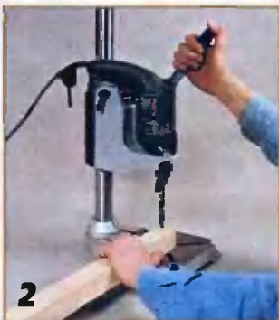
2 Сверление отверстий для обеспечения соосности выполняют с применением специальной стойки.
