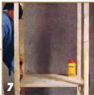
Основание G крепят на шурупах и клею к брускам обвязки В.
