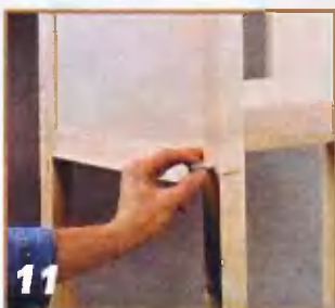
Под ось вращения столешницы К3 в отверстия в передних ножках вставляют отрезки металлических трубок.
