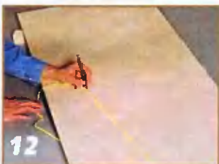
Дверцы K1, K2 и столешницу К3 выкраивают из заготовки К размерами 1576x632x18 мм.
