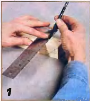
1 Для разметки положения отверстий под шканты на концах брусков чертят квадраты с диагоналями.
