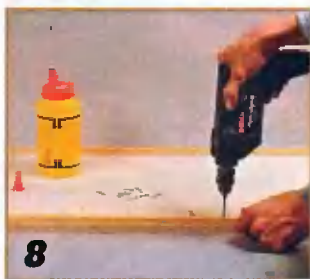
Штапики, служащие для крепления панелей М, N обшивки к каркасу шкафа, смазывают клеем и приворачивают саморезами по периметру панелей.
