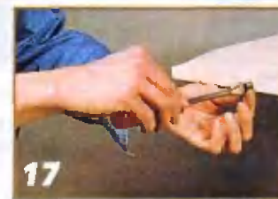
Резьбовую гайку-втулку необходимо ввернуть в подготовленное отверстие заподлицо.
